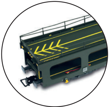
Version modernisée des mains courantes sur le pont supérieur
