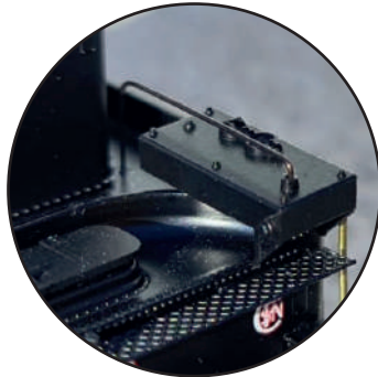
Réservoir à T.I.A sur le tender
