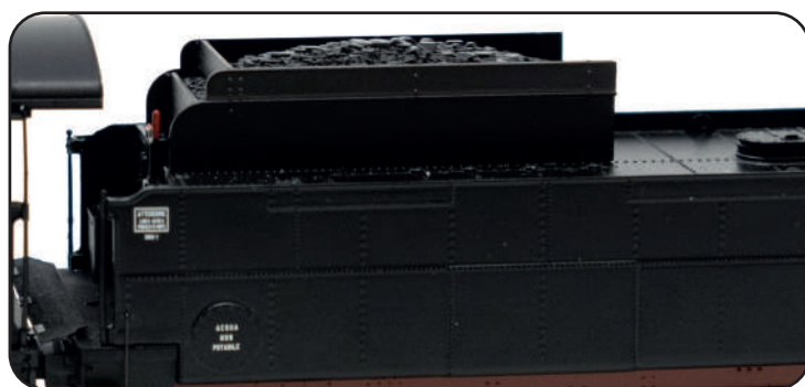
Tender con sopralzo carboniera e chiodature aggiuntive
