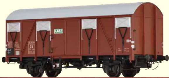
Gedeckter Güterwagen Gmms40 "Kali" DB Betriebs-Nr. 281 364
