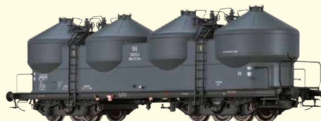
Staubbehälterwagen KKds55 DB Betriebs-Nr. 358 022
